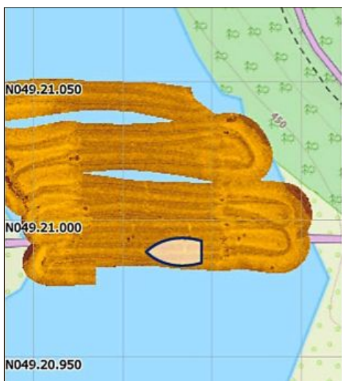
Die Fahrtroute des Vermessungsbootes (links). Der Seegrund ist nun im Bereich der Brücke genau vermessen.
